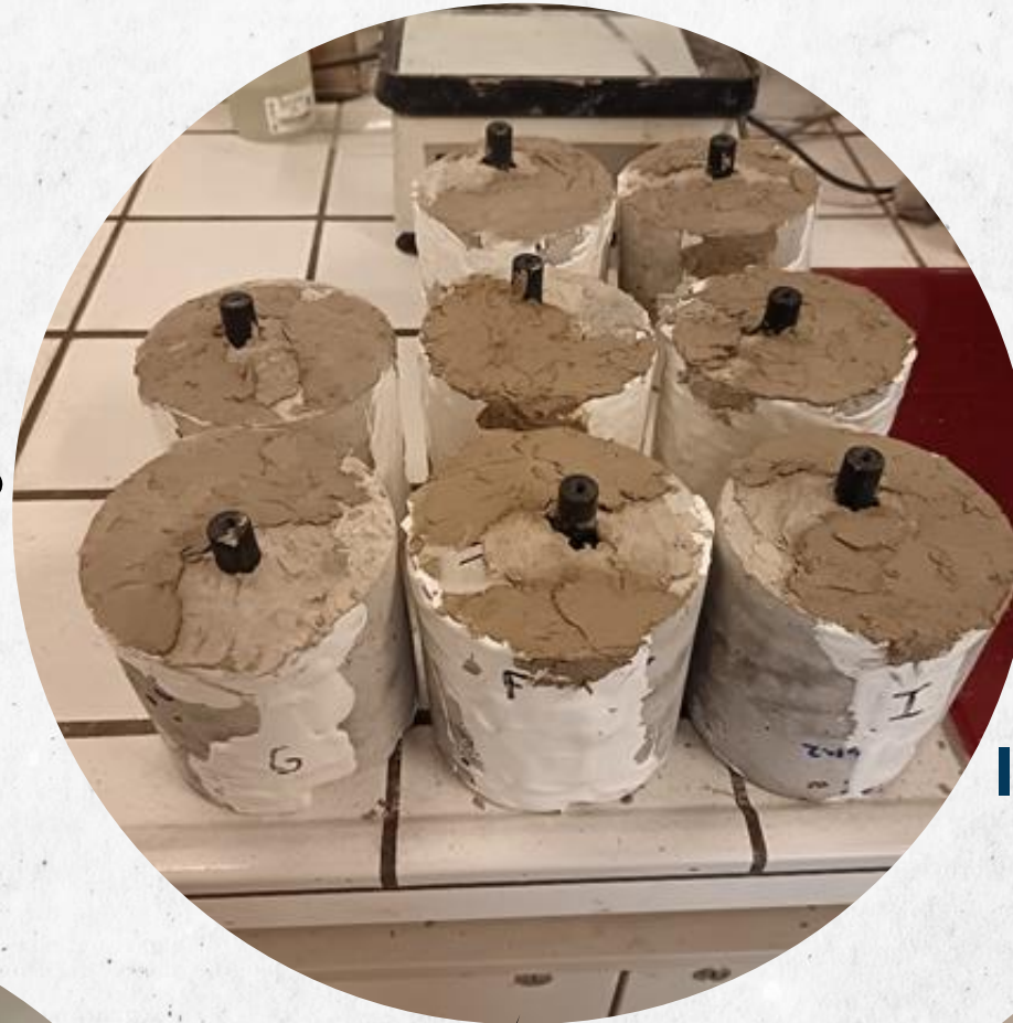
Collage des têtes et pontage des fissures
