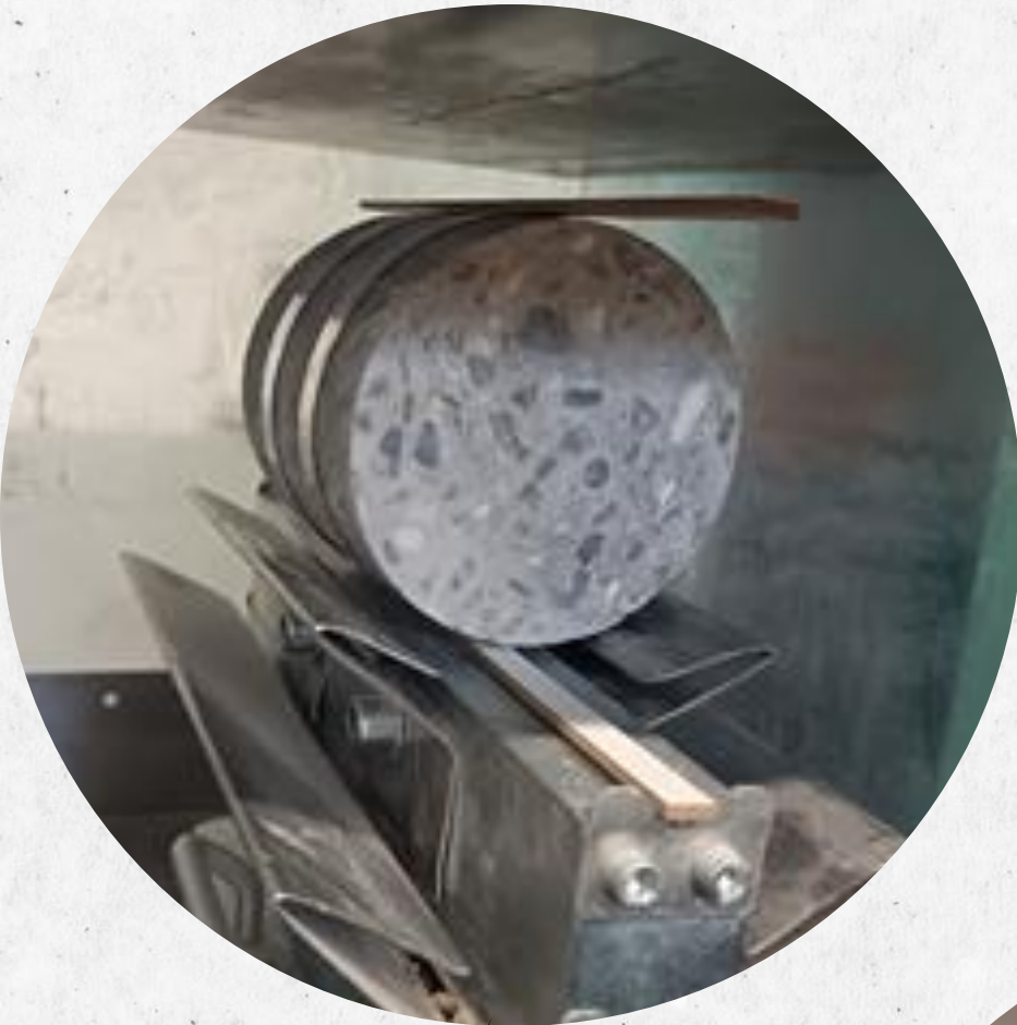
Fendage d'éprouvettes confinées
