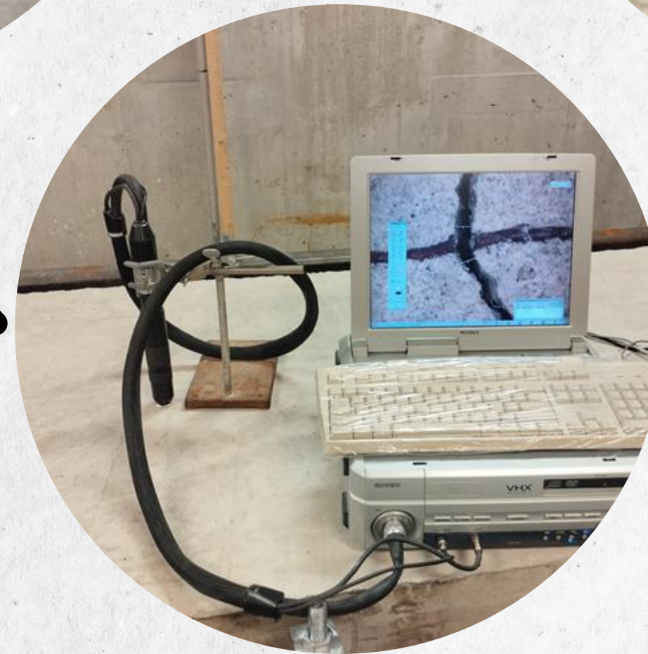
Mesure des ouvertures
