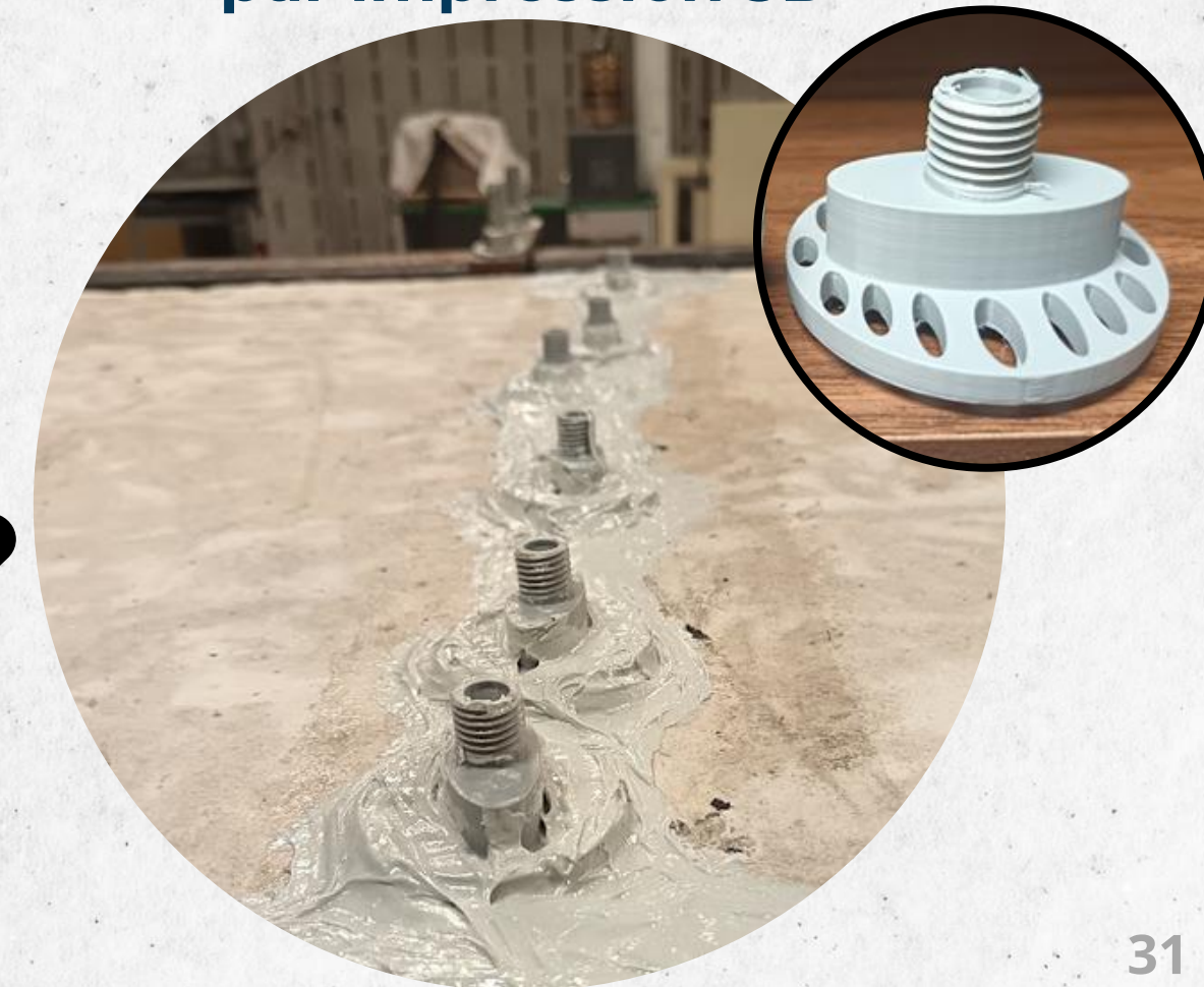
Têtes collées conçues par impression 3D
